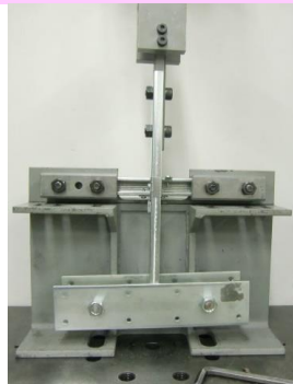
Y方向取付状態
